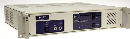
Las estaciones VHF permiten la comunicación aire-tierra entre el piloto de la aeronave y el controlador del tráfico aéreo en suelo, lo que permite la transmisión de mensajes del servicio de Control del Tráfico Aéreo (ATC) para las operaciones en las Áreas de Control Terminal (AFIS, TWR y APP ) y en ruta (ACC) a través de las estaciones remotas VHF.
